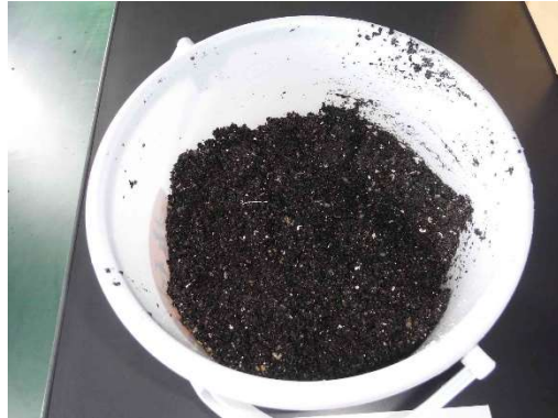
写真-19 通常洗浄後洗砂（混合Ⅱ）
