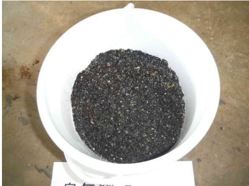
写真-16 通常洗浄後洗砂（混合Ⅰ）
