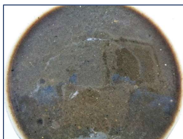
写真-10 凝集前汚泥
