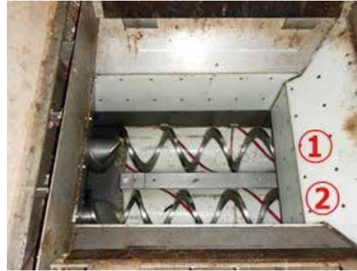
写真-8 スクリューコンベヤ
