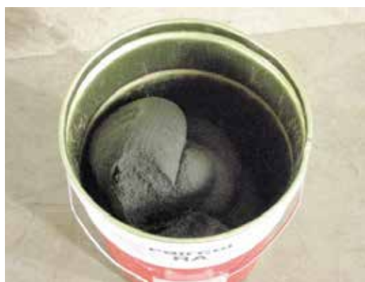
写真-1 脱水汚泥
