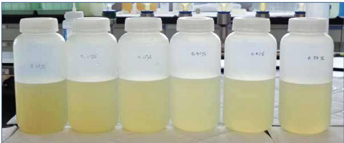
2/19 分離液 (左から0.25、0.30、0.35、0.40、0.45、0.50%) 写真-9 11回目 (冬季) ビーカーテスト分離液
