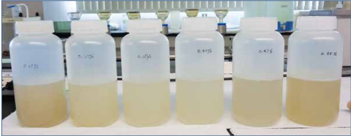
8/28 分離液 (左から0.25、0.30、0.35、0.40、0.45、0.50%) 写真-7 6回目 (夏季) ビーカーテスト分離液
