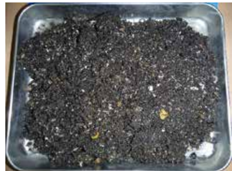
写真-113 2度洗い後洗砂 (混合Ⅲ)
