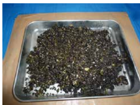
写真-100 通常洗浄後洗砂 (混合 I)
