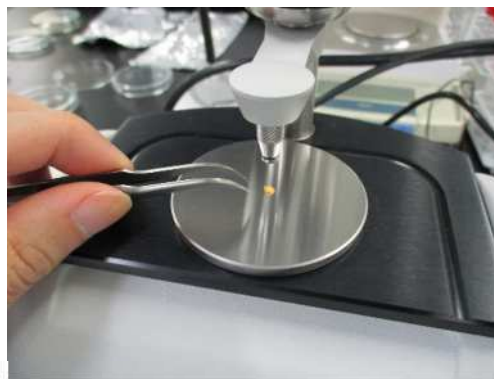
写真-14 ATR法による測定状況
