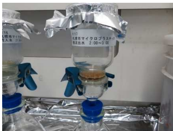
写真－8 フェントン処理中
