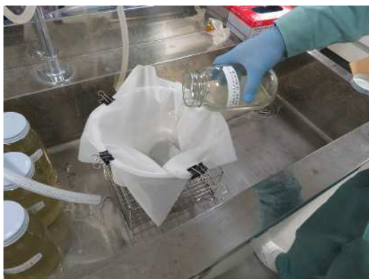
写真－5 ろ過状況（流入水、初沈出水）
