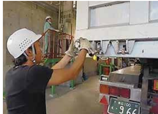
写真-16 荷台ドレインロック閉鎖状況
