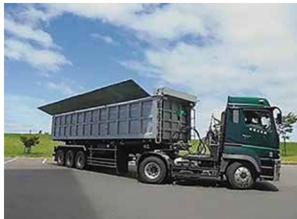
写真-4 汚泥運搬専用車両 (24トン)
