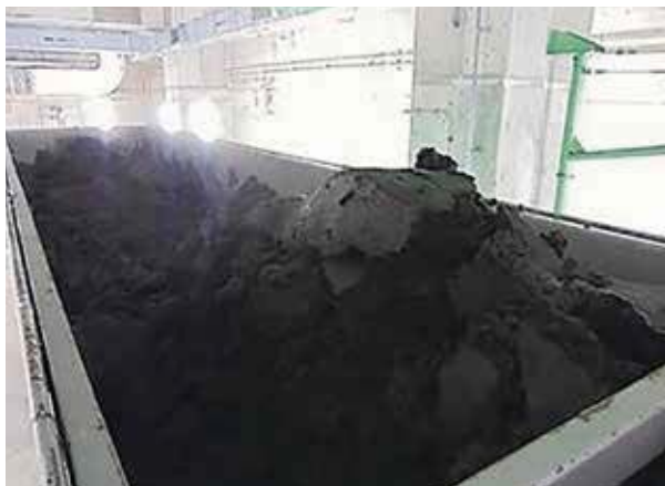
写真-3 脱水汚泥
