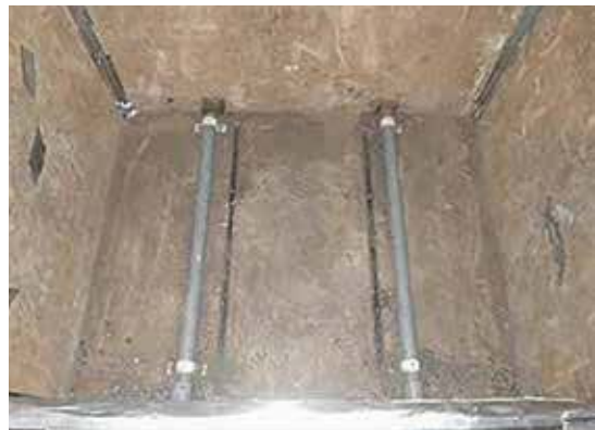
写真-8 テスト槽内通気部
