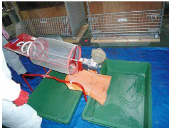
写真-9 電動ふるい（0.04kW：100V、目幅：4mm）
