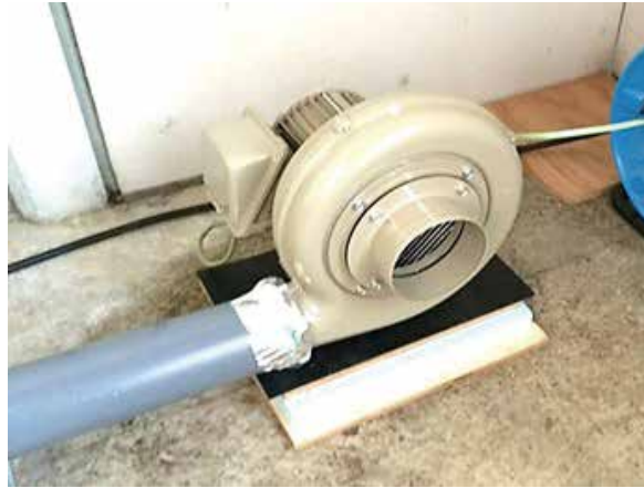
写真-6 ブロワ (0.1kW : 100V)
