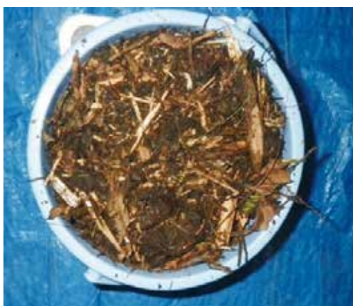
写真－3 脱水汚泥と副資材の混合物
