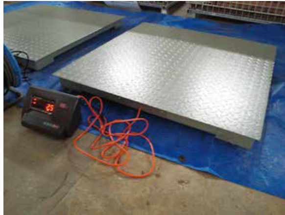
写真-8 フロアスケール（最小計測誤差：±0.5kg）
