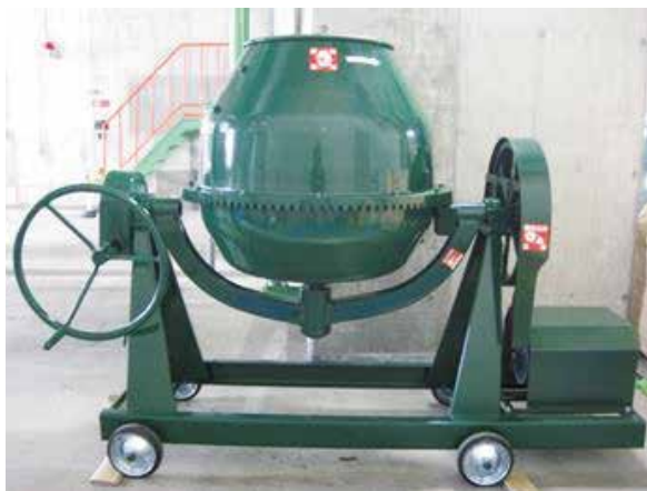
写真－4 ミキサー（750W：100V、容量：60L）
