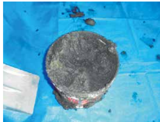
写真-13 脱水汚泥の採取
