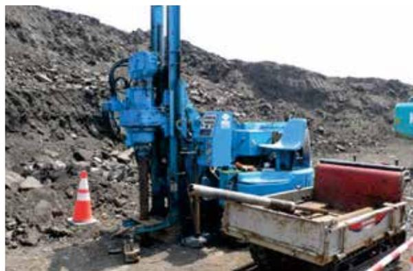
写真-1 ボーリングによる試料採取状況
