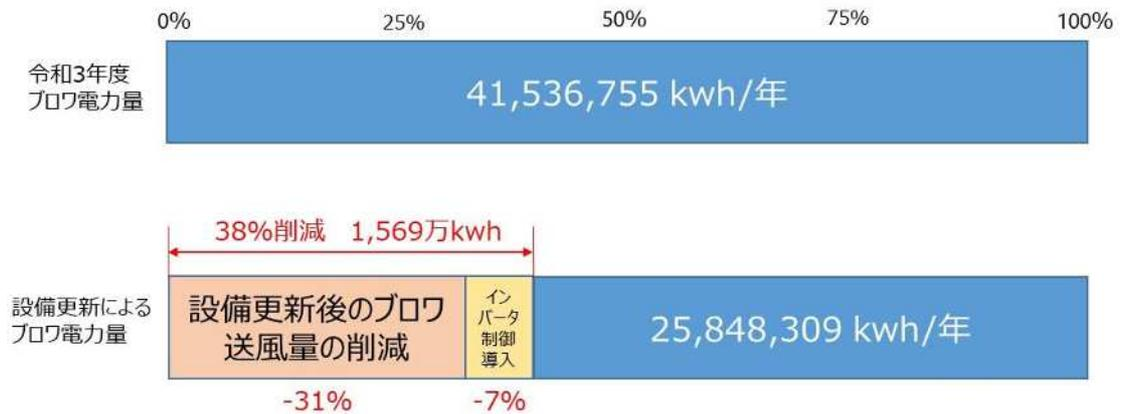
図-1 設備更新による電力量の削減予測
